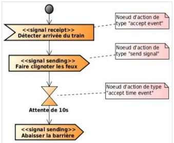
du train. Deuxièmement, "faire clignoter les feux" est une action "send signal", cela veut dire que le système envoie un signal qui est transmis à un objet cible sans attendre que ce dernier ait bien reçu ce signal. Ensuite, l'action "time event" est un événement temporel déclenché après l'écoulement d'une certaine durée. Enfin, "abaisser la barrière" est une action "send signal", un message est envoyé et transmis à la cible.
