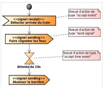
Nous distinguons ainsi graphiquement les actions associés à une communication: send signal, accept event et accept time event. Cela permet de mieux mettre en valeur les échanges entre les diagrammes de la spécification.
