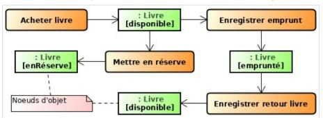
et cibles. Le nom d'un état, ou d'une liste d'états, de l'objet peut être précisé entre crochets après ou sous le type de l'objet. Nous pouvons également préciser des contraintes entre accolades, soit à l'intérieur, soit en dessous du rectangle du nœud d'objet.
